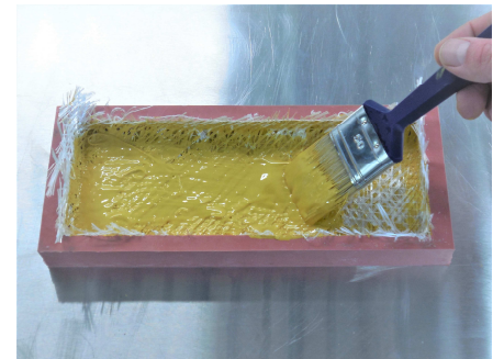
Fig. 6: De rest van het mengsel wordt aangebracht op het Triaxaal doek.
