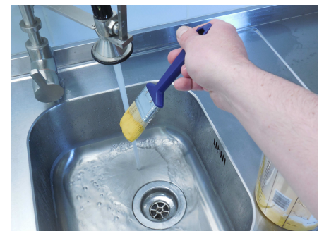
Fig. 7: Materiaal is eenvoudig met water te reinigen indien de hars nog niet is uitgehard.
