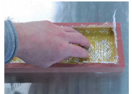
Fig. 5: Een eerste strook Triaxaal glasweefsel wordt voorzichtig in de hars gedrukt.
