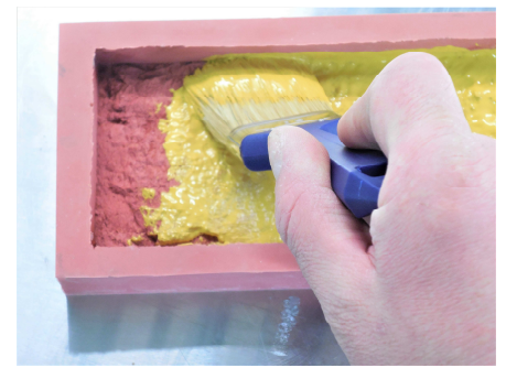
Fig. 4: De eerste laag wordt met een kwast aangebracht
