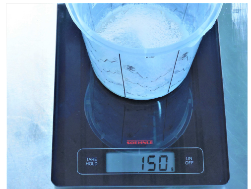
Fig. 2: 150 gram Acrylhars vloeistof met 100 gram Acrylhars poeder.
