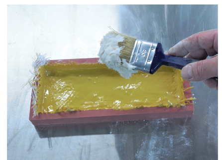
Fig. 9: Het mengsel van Hars met gekapte glasvezel wordt aangebracht op de nog verse laag acryl.
