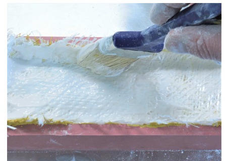
Fig. 11: De laatste laag hars wordt aangebracht.
