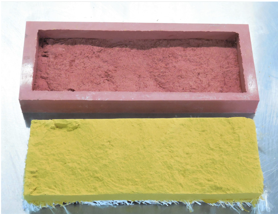
Fig. 12: De mal samen met de afdruk in Acrylhars.
